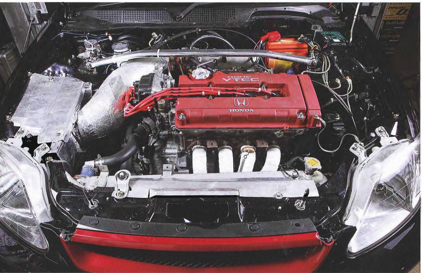
されたB18Cエンジンは、ピストンやメタルなどの摺動部にWPC加工が施されているもの、基本的にはすべて純正部品を使って組み上げられたもの。インタークまわりでは、吸気温の上昇を抑えるための断熱処理気をつかっている。
