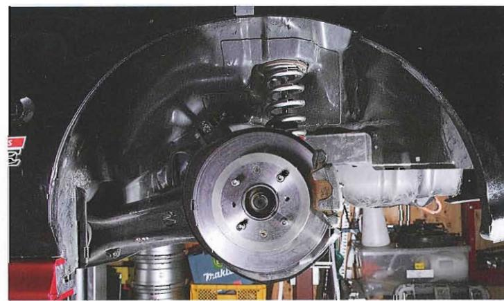
タイヤをクムホV700に変更したのに合わせて、足まわりもスピリットレーシング製のダンパーをベースに、新たにセットアップされた。スプリングレートは、フロント22kg/mm、リア20kg/mmを組み合わせる。
