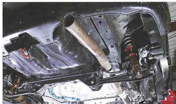
ワンオフで仕上げられたマフラーは、腹下に最低限のサイレンサーをセットするものの、軽量化を優先してテールパイプはシンプルに排気管を取り回すだけのレーシーなデザインに。
