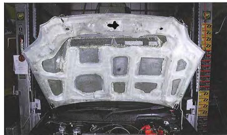
FRP製のボンネットには、ラジエターを通った熱気を抜くためのボンネットダクトが設置される。大容量のラジエターと組み合わせることで、水温は75度とかなり低めで安定する。
