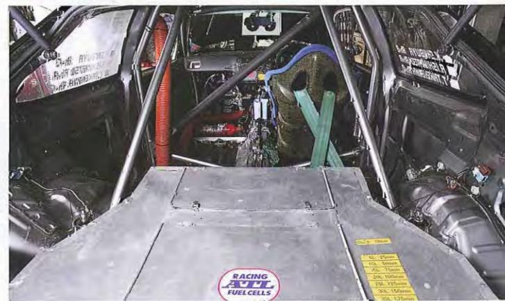
安全タンク装着のため、当然ながら燃料計は非装着だが、安全タンクとコレクタータンクの間には、燃圧計がセットされ、メインタンクが空になるとワーニングで警告する対策が施されている。
