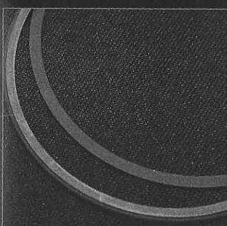
ピストンリング：左が未処理。右がWPC+DLC。サイド面のみのDLC加工はワークスなどでも行われているが、ピストンと接触するリング上面も処理をしておきたい。
