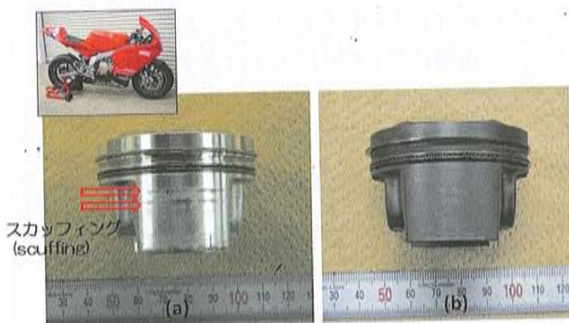
図 7. エンジン試験後の外観写真 (a) 未処置、(b) DLC 被覆
