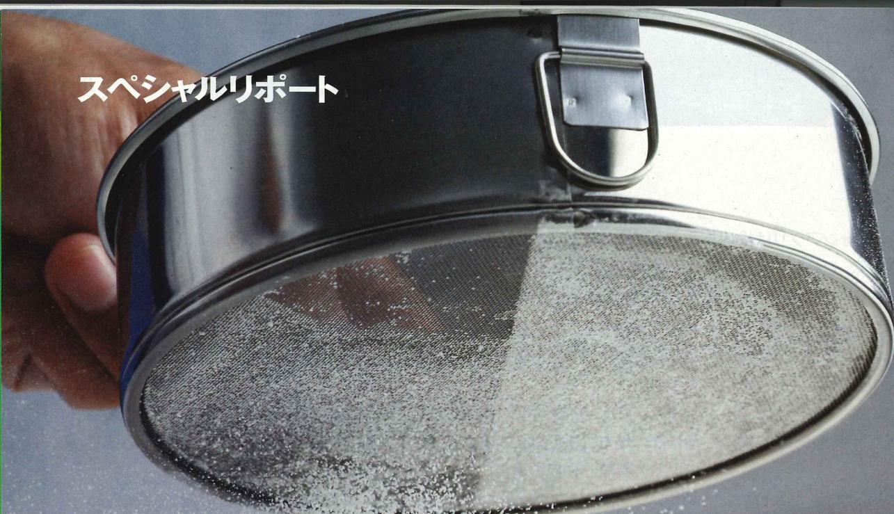
WPC処理をすると粉が網に残らなくなり歩留まりが上がる(上)。表面につけた目では見えない微細な凹凸(下左)が滑りをよくする。ギアなどに使われる処理方法を応用した
