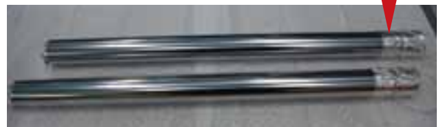
オートバイのフロントフォークへのDLCコーティング。不要部分にはアルミシートでマスキング処理を施します。
