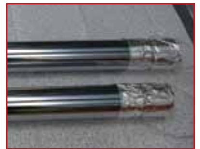
オートバイのフロントフォークへのDLCコーティング。不要部分にはアルミシートでマスキング処理を施します。
