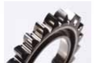
研磨 必要に応じて鏡面仕上げ用ブラストマシンで、磨きます。
